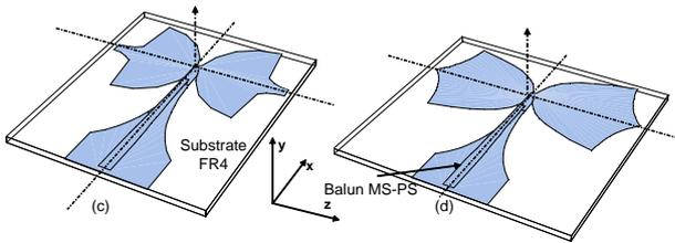
Fig. 2. Antenna geometries with balun.(c) CC-PS structure. (d) EE-PS structure
