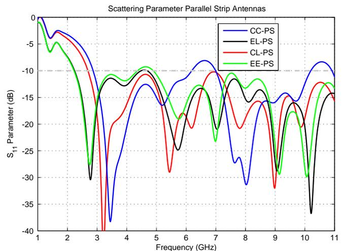
Fig. 3. Return loss of PS-antennas.
